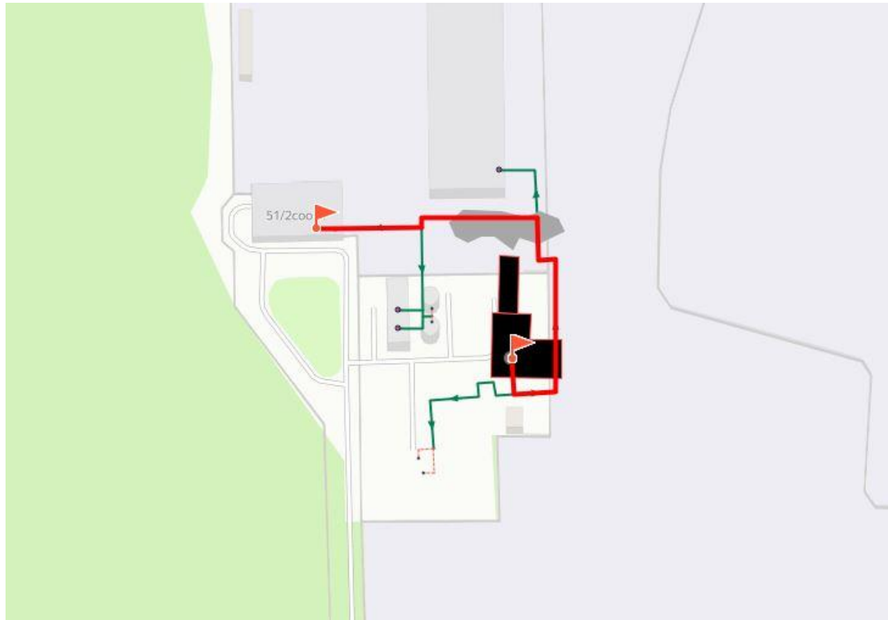
Рисунок 3.55 – Путь движения теплоносителя от источника тепловой энергии до конечного потребителя, в зоне действия котельной №1 ПАО «Сургутнефтегаз» (рисунок П46.1 МУ)
