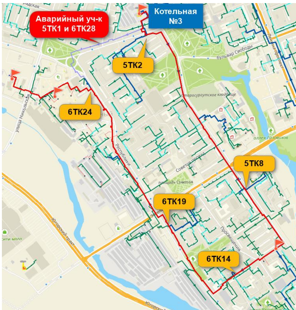
Рисунок 9.18 – Смоделированная аварийная ситуация. Альтернативный путь движения теплоносителя
